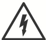
Das Blitzsymbol warnt in Verbindung mit dem Warnwort **GEFAHR** vor einer lebensgefährlichen elektrischen Spannung.
